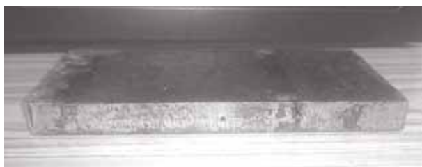
Figura 9. Imagen de la probeta utilizada en los experimentos hechos para el presente trabajo. Obsérvese el orificio localizado en la superficie frontal
