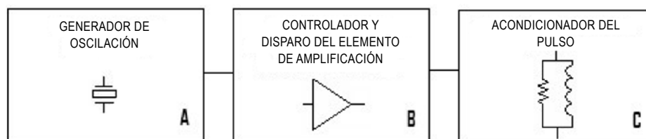
Figura 1. Diagrama de bloques del sistema de generación del pulso
