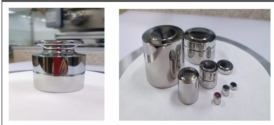
Figura 4. Pesas de referencia usadas para la calibración de pesas clase E_1 . (Izquierda: pesa de valor nominal 1 kg; derecha: juego de pesas “mejores que E_1 ”, en la imagen se observan las pesas en el intervalo de 1 g a 500 g)
