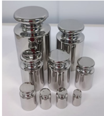
Figura 5. Pesas de prueba clase E 1 , en la imagen se presentan pesas de valor nominal 10 g a 1 kg
