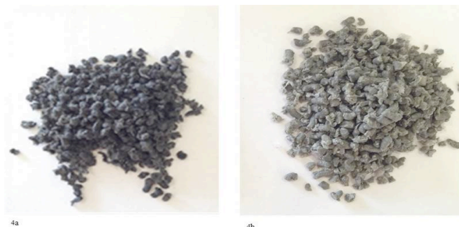
Figura 4. a) Pellets de \text{CaCO}_3/\text{PVC} , b) Pellets lodo/PVC
