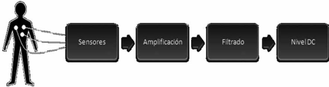
Fig. 2. Diagrama de bloques del módulo analógico.
